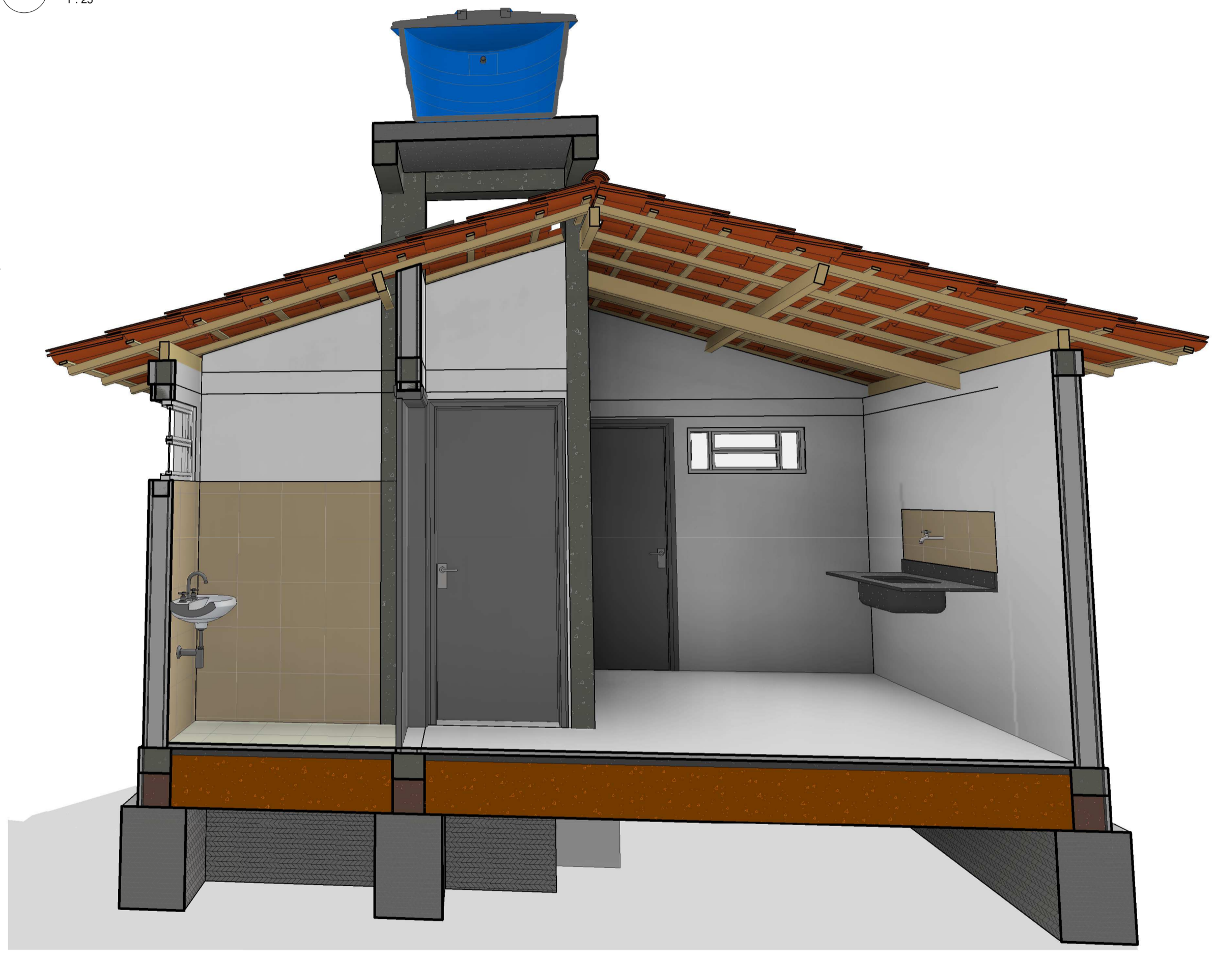
2 Corte AA madeiramento 1:25
