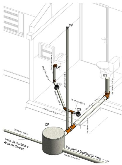
3 Isométrico Esgoto WC
