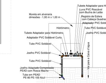
12 Detalhe do Hidrômetro
