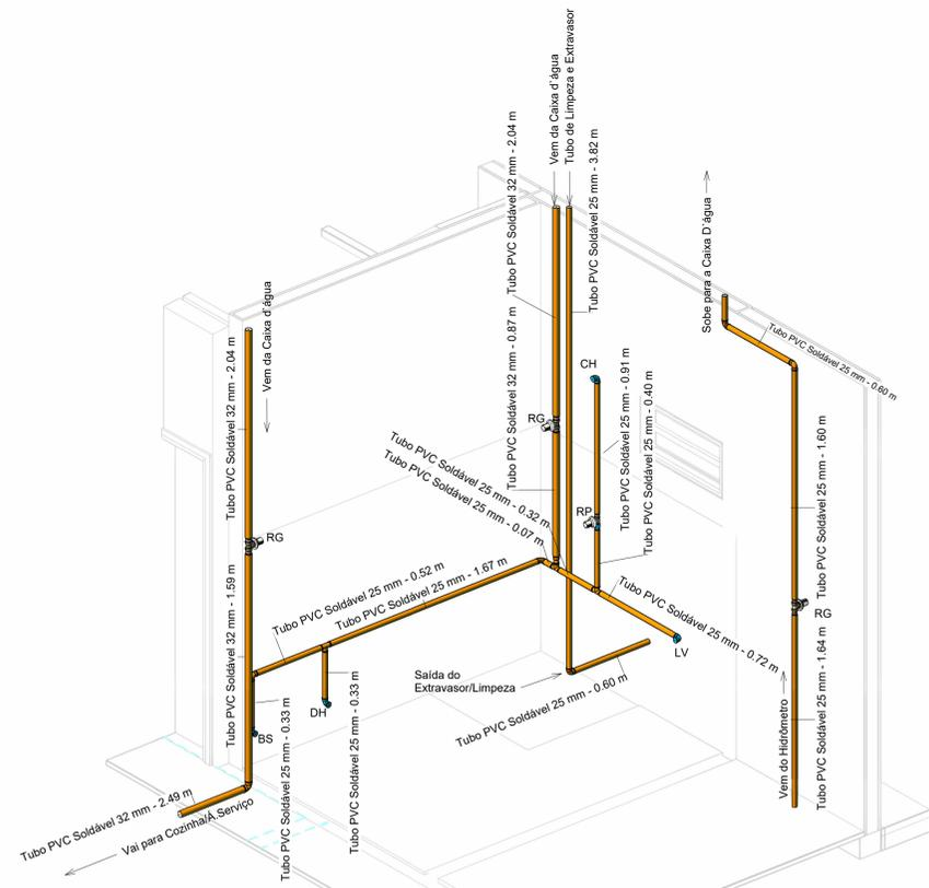
2 Isométrico WC hidráulico
