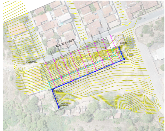
02 Planta terraplanagem e drenagem ESCALA 1/1000
