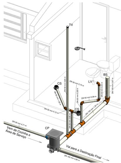
3 Isométrico Esgoto WC
